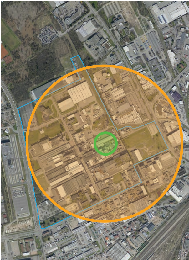
Einwirkungsradius (402 m) für eine Freisetzung von Ammoniak ohne Schnellschlusskupplung an den BKW-Entladearmen (orangene Fläche) sowie mit Schnellschlusskupplung (40 m, grüne Fläche)
